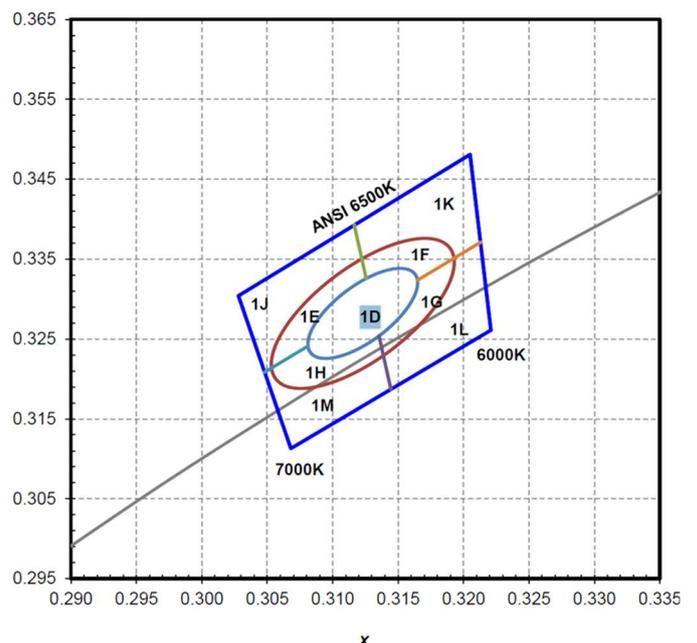
Abbildung 6: MacAdam 3 SDCM Ellipse mit ANSI °K Angaben. Die Tangenten zur schwarzer Körper Kurve entsprechen den jeweiligen Farbtemperaturen.
