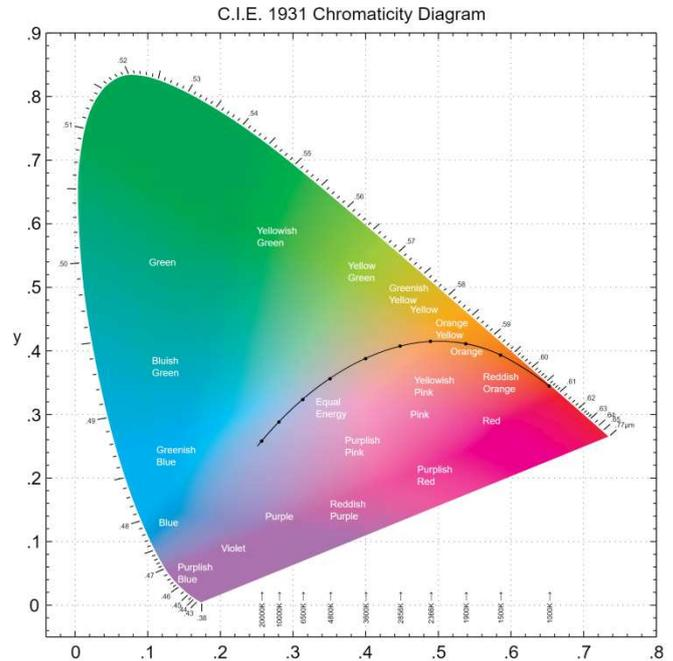
Abbildung 4: CIE 1931 Farbraum mit schwarzer Körper Kurve
